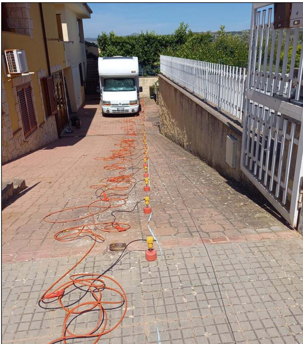
Figura 11 – Stendimento in sismica a rifrazione eseguito
